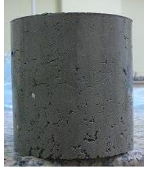
Şekil 3. Sıkıştırma işlemi yapılmış bir zemindeki hava boşlukları
